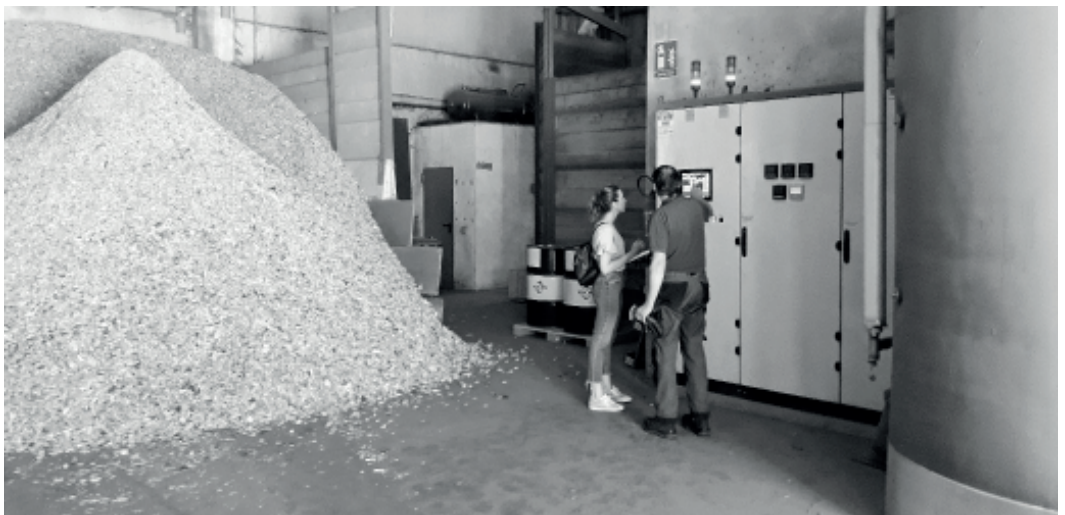
Figura 1 - Rilevazione parametri da sistema computerizzato in primo piano, uscita del cippato essiccato e vagliato (nella parte sinistra)
