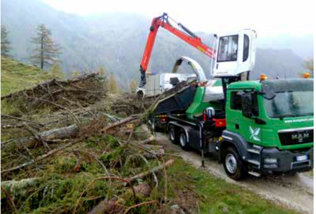
Foto 4 – Particolare delle operazioni di cippatura dei residui di utilizzazioni per liberare lo spazio del pascolo in un campivolo di una malga monticata. Foto C.F. S. Montibeller.
