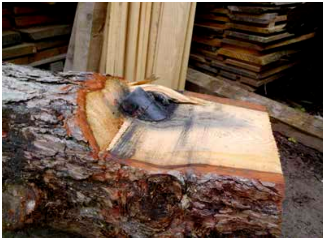
Foto 3 – Particolare danno rilevante presente in un toppo di larice con inclusione metallica dovuta agli eventi bellici della I Guerra Mondiale. Larice di età al taglio circa 150 anni, prelevato nel bosco “Rocolo del Compo” Q. 1650 m.sl.m. nell’anno 2014 – comune di Ronchi Valsugana (TN). L’inclusione era data da un proiettile di mortaio da 80 mm ancora carico. Dopo vari tentativi di disinnescamento volti a salvare il particolarissimo reperto, non si è riusciti a dichiarare il reperto bellico come inerte e si è dovuti procedere al disinnescamento tramite brillamento dell’ordigno. Il tronco è stato considerato come “perdita di lavorazione”. Foto C.F. S. Montibeller.
