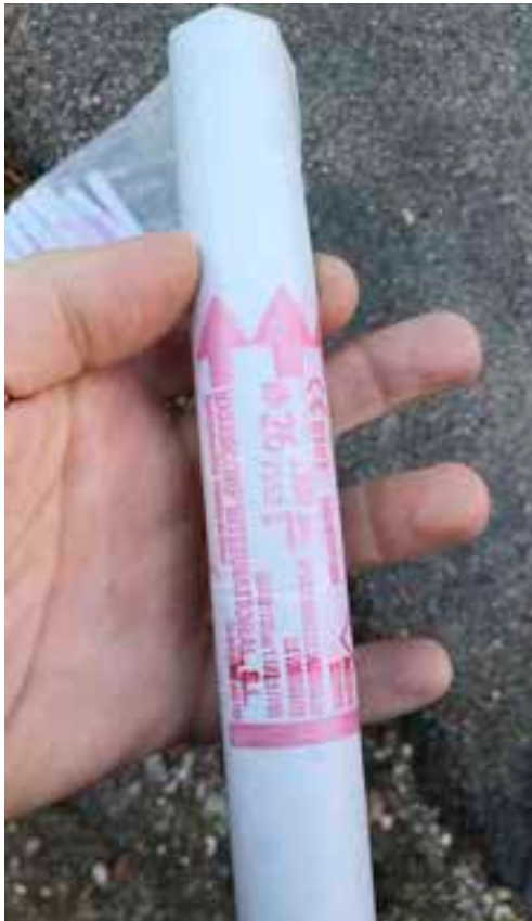
Foto 4 – Candelotto di esplosivo impiegato per le operazioni di messa in sicurezza ceppaie.
